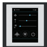
EHT3 Unidad de control con pantalla táctil
