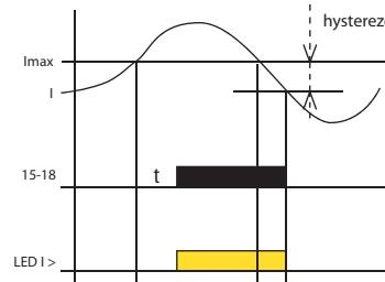
Hlídací relé PRI-52 slouží k hlídání úrovně proudu v jednofázových AC obvodech. Plynulé nastavení úrovně vybavovacího proudu předurčuje relé pro mnoho různých aplikací. Výstupní relé je v normálním stavu vypnuto. Při překročení nastavené úrovně proudu relé po nastavené prodlevě sepnese. Při návratu z chybového do normálního stavu se uplatňuje hystereze. Rozsah PRI-52 je možno zvětšit pomocí externího proudového transformátoru.
