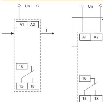
Příklad zapojení: PRI-52 s proudovým převodním transformátorem pro zvýšení proudového rozsahu.
