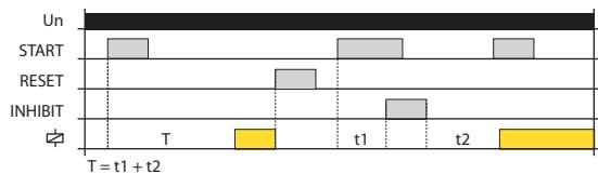
Po přivedení napájecího napětí je relé rozepnuto. Je-li sepnut ovládací kontakt START, začne časové zpoždění T. Po ukončení časování relé sepne. Sepnutí ovládacího kontaktu START v průběhu časování je ignorováno.
