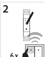
Stiskem programovacího tlačítka na dobu 1 vteřiny na RF prvku RFSA-61M/MI (66M/MI) se prvek uvede do programovacího režimu. LED problikává ve vteřinových intervalech.
